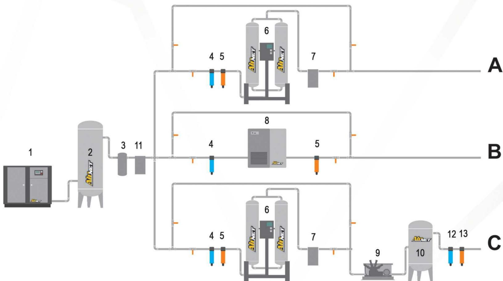
1 کمپرسور اسکرو | 2 مخزن هوای فشرده | 3 تله آبگیر | 4 میکرو فیلتر اولیه | 5 میکرو فیلتر ثانویه | 6 درایر جذبی
